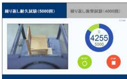
図2 家具耐久試験機の遠隔監視画面
