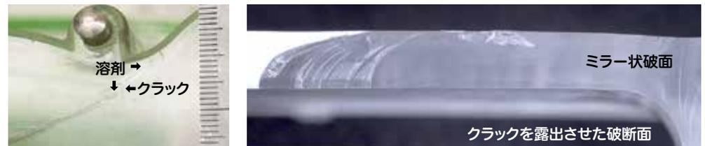
図1 ポリカーボネート樹脂の破面
