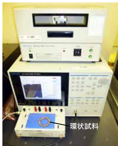
図2 交流磁化特性測定装置で金属の環状試料を測定している様子
