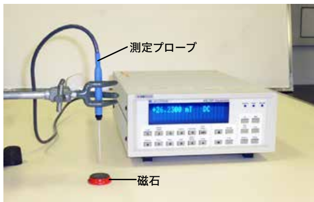
図1 ガウスメータで磁石の磁束密度を測定している様子
