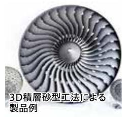
3D積層砂型工法による製品例
