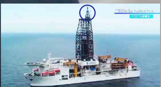
ちきゅう（地球深部探査船）で使用されているPDCE避雷針
