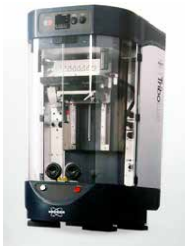
写真1 トライボロジー多機能試験機 (米BRUKER社製 UMT TriboLab)
