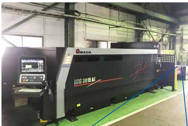
レーザー加工機 全景
