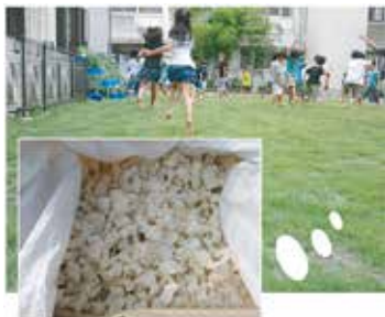
ウレタン製土壤改良材「ナテルン」 (小学校中庭芝生の土壤改良材で使用)
