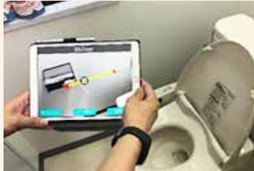
写真1 アプリで設置する手すりの長さを測定
