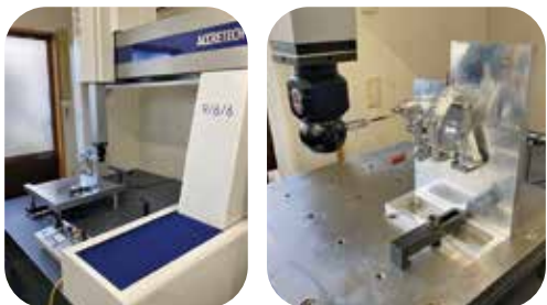
CNC全自動三次元測定器写真と測定シーン写真
