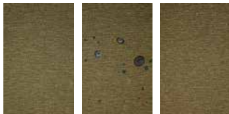
ガス試験前 防さび処理なし（ガス試験後） 防さび処理あり（ガス試験後） ※写真は金めっきです
