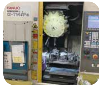
自社製加工治具写真と自社治具、インデックス、マシニングカスタマイズ加工機写真
