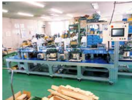
設備貸与制度を利用して導入した 特殊ナット自動組み立てライン
