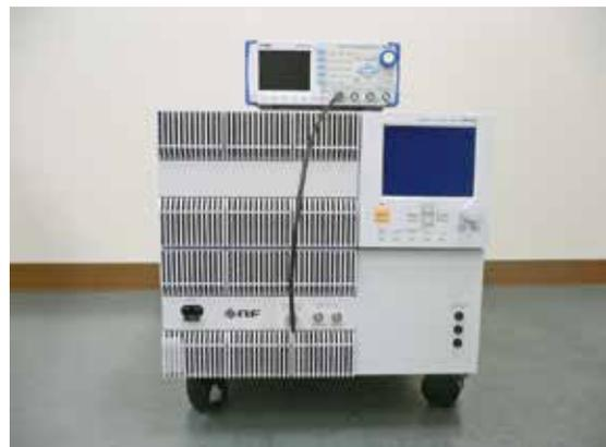
車載機器用電圧変動試験機
