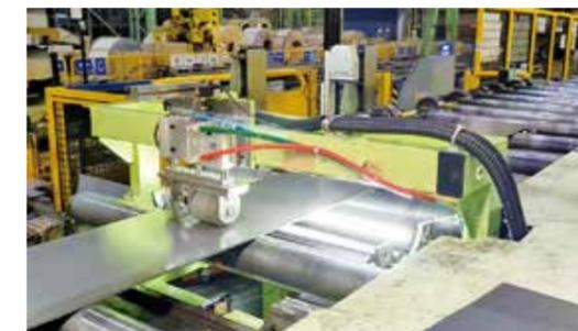
\* 伊藤忠丸紅鉄鋼株式会社・東京スチールセンター株式会社と共同で開発した、AI外観検査システムのプロトタイプ
