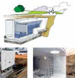
1つの土地に2つの機能! フットサル場や駐車場の地下には、当社の調整池が活躍
