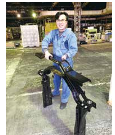
トラックの運転席を支える部品。乗り心地や疲労感を左右する。心を込め生産します
