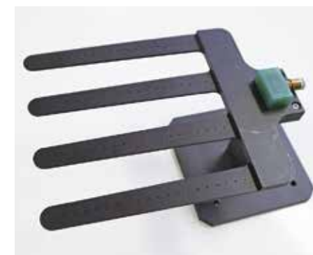
小型のロボットハンド。指の部分に空けた穴から空気を送り出し、ものを持ち上げる
