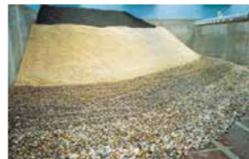
浄水場で原水をろ過するフィルターの役目を担う「ろ過砂」
