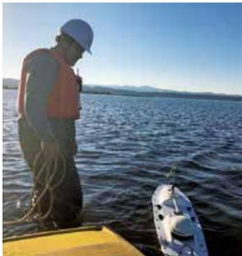
▲GPS・ソナー搭載の自律航行無人リモコンボートで、海底の地盤高を測定する
