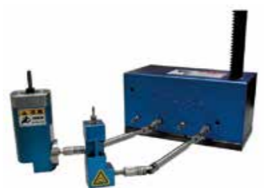
金型とプレス、2つの技術を融合させた「タップング(ねじ切り)ユニット」。日本では2005年に特許を取得している
