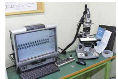
線材の直径0.025mmのばね
