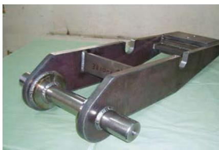
レーザー加工+溶接+機械加工
