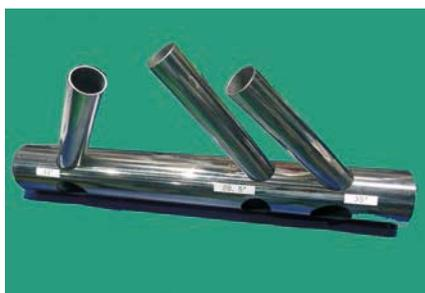
3次元レーザー機によるパイプ加工
