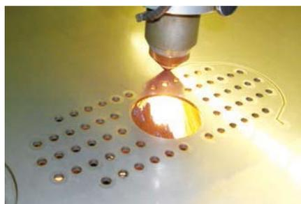
ステンレス板の多孔加工
