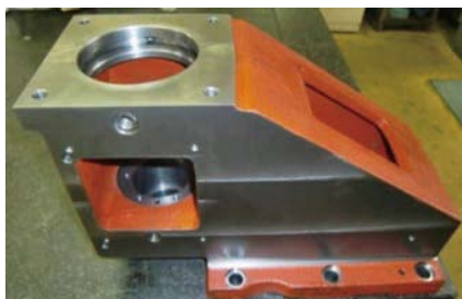
工作機械部品 FC250 直角：0.005 平面：0.01 同軸：0.01
