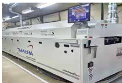
リフロー設備
