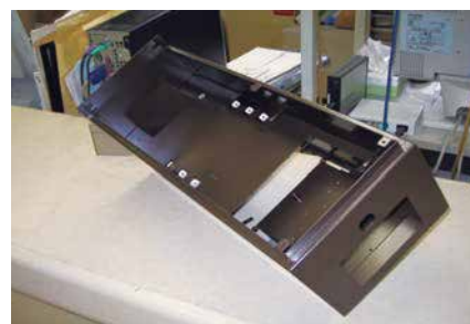
処理鋼板溶接
