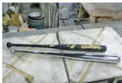
鏡面仕上げ前（上）仕上げ後（下）
