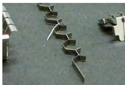
V A提案例。CSP T=0.1 曲げのみによる溶接のないハニカム形状
