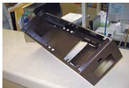
処理鋼板溶接
