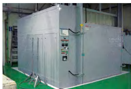
新設バッチ式大型ガス炉
