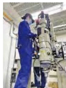
ジグ研削盤のメンテナンス
