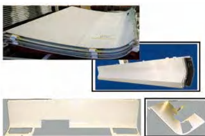
上からN700側天井・E257 腰中ダクト・E233側天井
