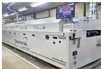
リフロー設備
