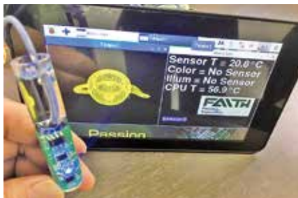
IoT耐環境センサユニット（デモ機） 電機及びケース設計・基板実装・組付け・ポッティング
