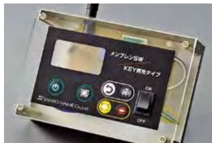
透明スイッチシート 接点が透明でスイッチ部分に遮る回路が無く、意匠の幅が広がります。例えば、接点の下にLEDを配置すればKEYを発光させる事が可能です。
