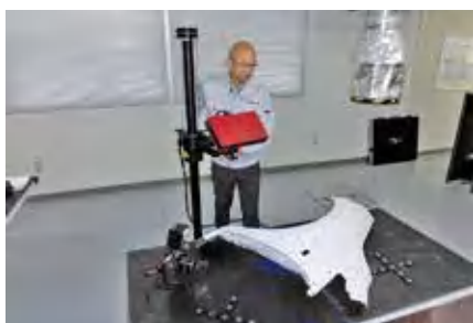
非接触3次元測定(自動車パネル)
