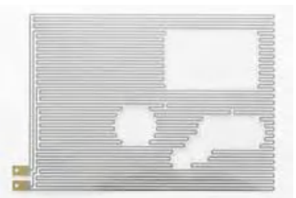
印刷ヒータ PETにAgペーストを印刷したヒータです。厚みが0.3mm以下と非常に薄くスクリーン印刷で製造する為SUS箔ヒータより安価です。
