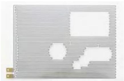
**印刷ヒータ** PETにAgペーストを印刷したヒータ
