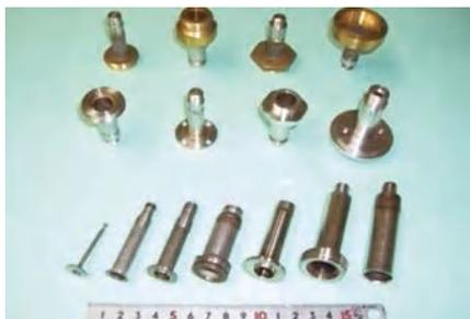
各種電磁弁部品
