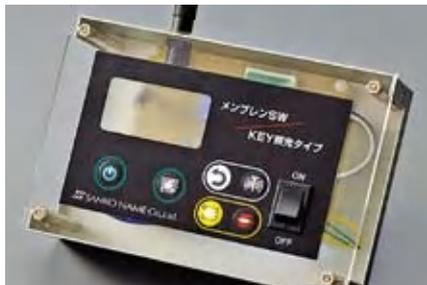
**透明スイッチシート** 接点が透明でスイッチ部分に遮る
