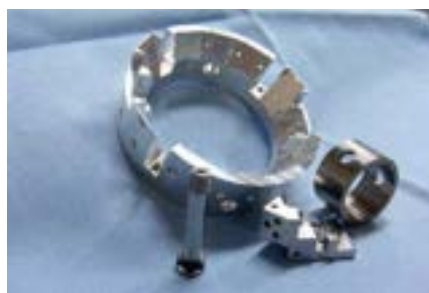
金属複合加工品 (SUS、NAK、チタン他)
