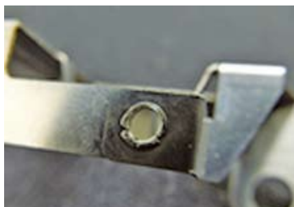
ベアリングかしめによる組立構成
