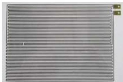
印刷ヒータ PETにAgペストを印刷したヒータです。厚みが0.3mm以下と非常に薄くスクリーン印刷で製造する為SUS箔ヒータより安価です。
