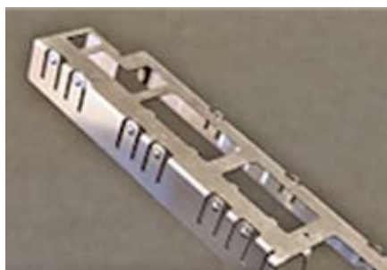
SUS304CSP-1/2H t=0.15 全長：500mm 加工精度：+0.03 -0
