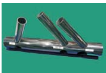
3次元レーザー機による パイプ加工
