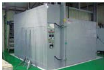
新設バッチ式大型ガス炉
