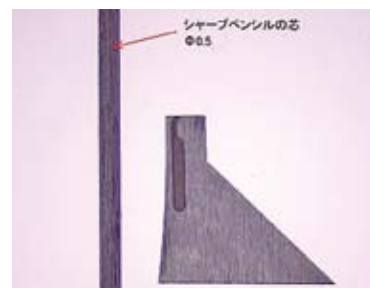
NC放電加工品 超硬G5 溝の幅0.1
