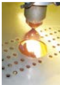
ステンレス板の 多孔加工
