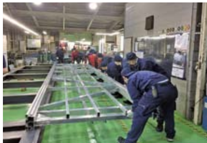
フレームの溶接・組み立て
