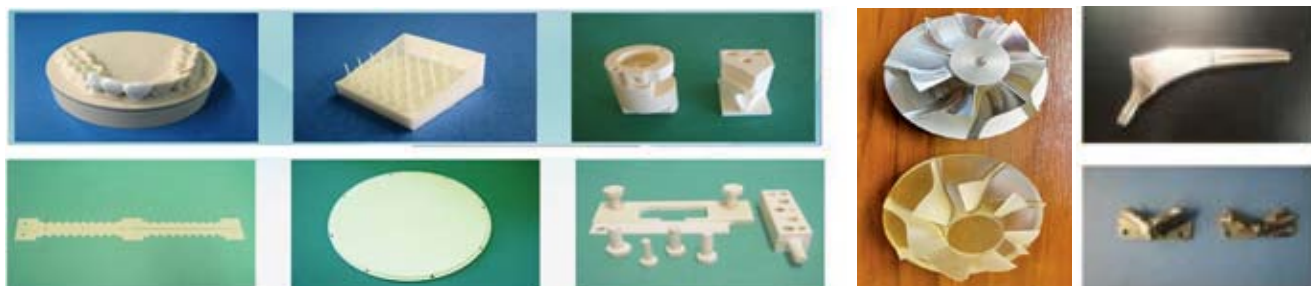
各種セラミックス素材加工サンプル・加工設備：超音波ロータリー加工機
