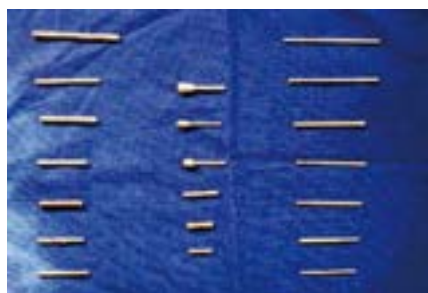
横孔加工、先端ローリングしたパイプ部品
