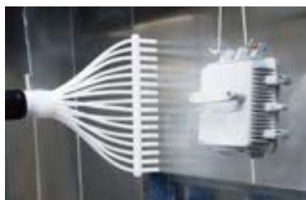
摩擦帯電方式粉体塗装
