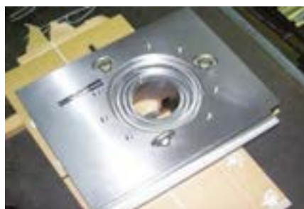
鍛造品斜めボーリング加工
