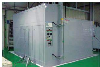
新設バッチ式大型ガス炉
