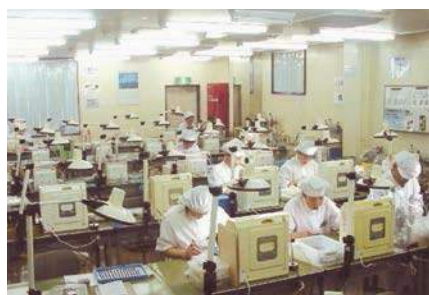
クリーンルーム（クラス10000）：88㎡
