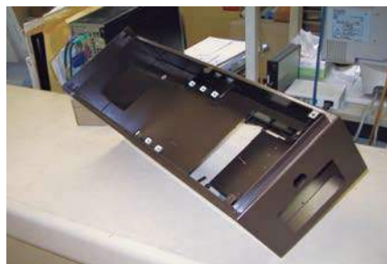
処理鋼板溶接
