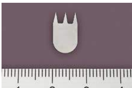
先端R6μmの針先形状加工 (シャープエッジ加工)
