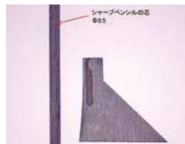
NC放電加工品 超硬G5 溝の幅0.1
