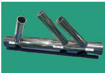
3次元レーザー機によるパイプ加工
