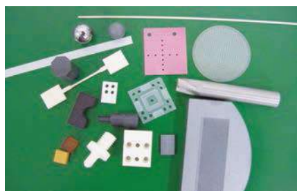
各種セラミックス材の 微細部品加工例
