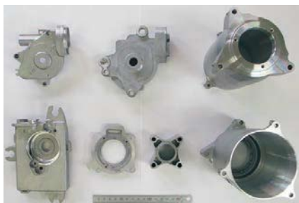
アルミダイカスト製品の切削加工
