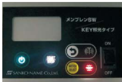
メンブレンスイッチの厚み約1.5mm でキーを照光させデザイン性、操作性を向上させました。
