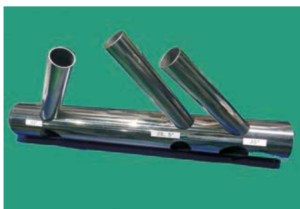
3次元レーザー機によるパイプ加工
