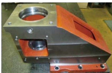
工作機械部品 FC250 直角：0.005 平面：0.01 同軸：0.01
