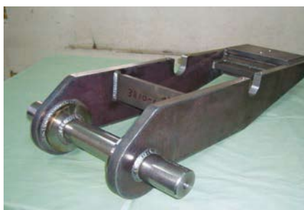
レーザー加工+溶接+機械加工
