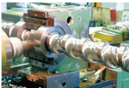
NCネジフライス盤 (ワンダラー) によるスクリュー加工
