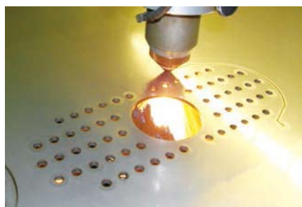
ステンレス板の多孔加工
