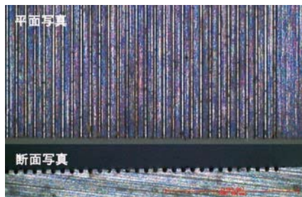
微細溝入り試験片 (CVT開発用) 溝深さ0.03×溝幅0.03
