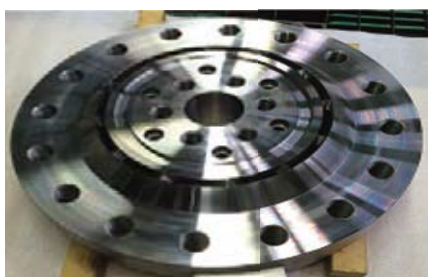
樹脂金型部品 S45C φ560×H125 樹脂流路部 ワイヤ加工 五軸加工有り
