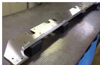
真空装置部品 SUS304 研磨仕上げ 1715×191.5×t20 平面度：0.01
