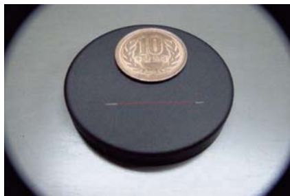
コンタクトチェッカープローブピン (φ0.09mm×30mm)
