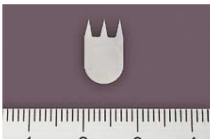
先端6μmの針先形状加工 (シャープエッジ加工)
