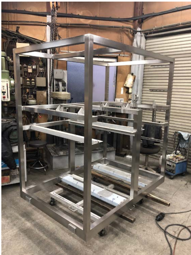
写真4 SUS304 角パイプ架台 (食品関連の製造ライン) Size 1740x1200x H1845
