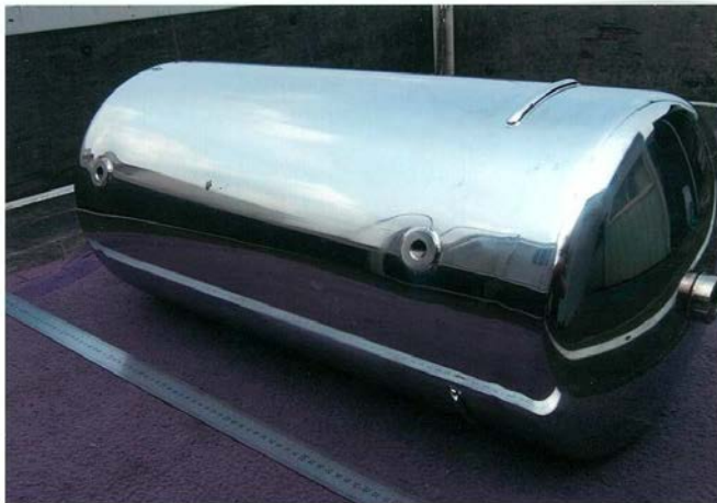
写真1 水タンク（防衛産業向け） SUS304 6t 本体胴 Size 胴部φ350xL800
