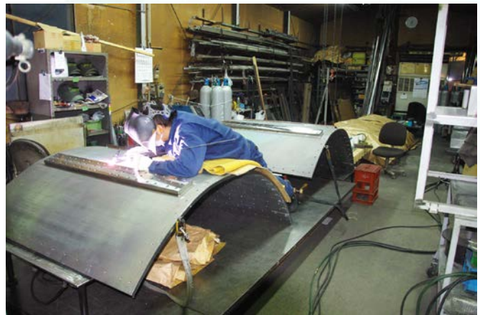
写真2 放射光施設ビームライン 真空チャンバーSUS316L Size 1500x1200x H300
