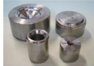
エンジンバルブ用鍛造金型
