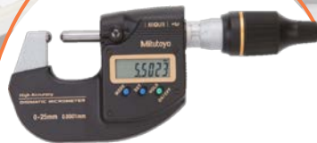
0.1 \mu m測定を可能にした デジマチックマイクロメータ
