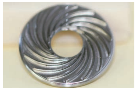
高速加工機によるマイクロタービン製作 (輸送機器向過給機)
