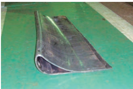
蒸気タービン LO 中空ノズルの製作 (金型も含め)
